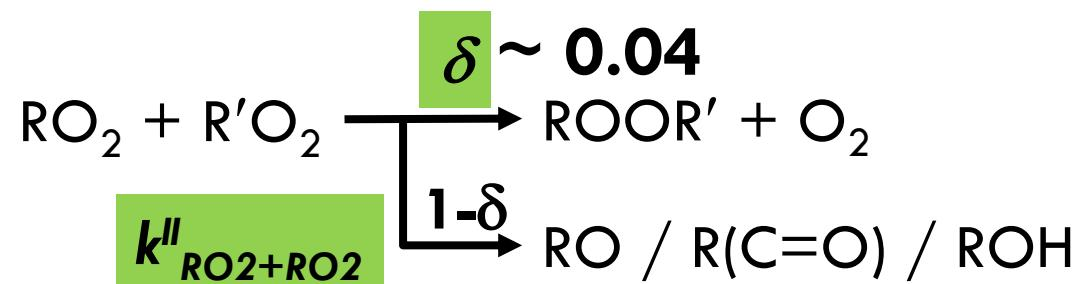
$$\sim 2 \times 10^{-12} \text{ cm}^3 \text{ molec}^{-1} \text{ s}^{-1}$$
